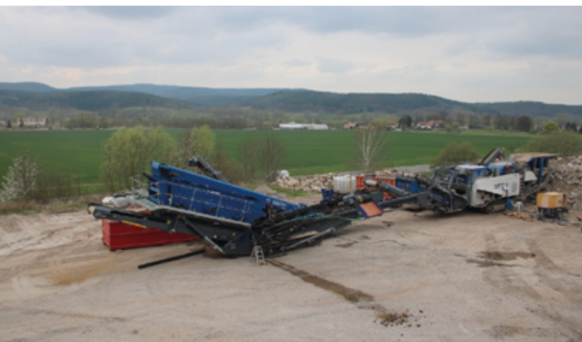
Mobile Bauschuttauflarbeitungsanlage mit Brecher, Sortierung und Siebstation.
