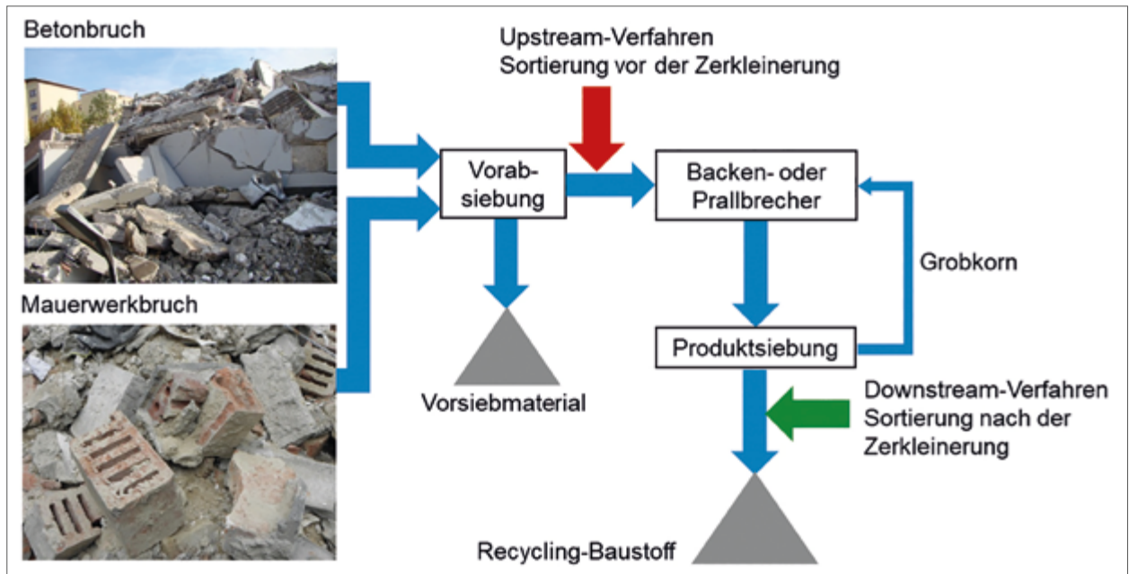
Einordnung der Sortierverfahren in den Verfahrensablauf.
