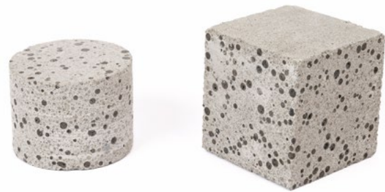
Infraleichtbeton-Proben – Rezeptur mit Blähton und Blähglas.
