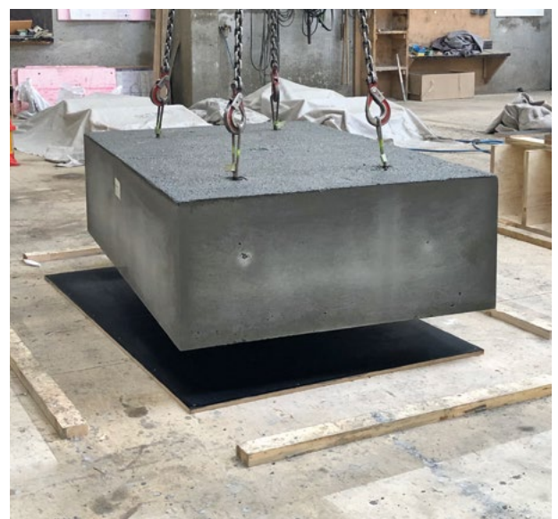
Prüfplatte zur Untersuchung der Frühfestigkeit von Infralichtbeton.
