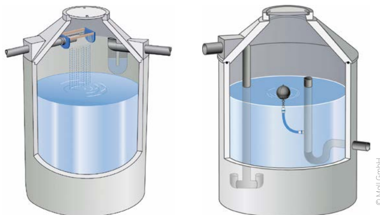
Schematische Darstellung von Regenwasserzisternen.
