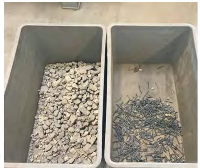
Ergebnis kamerabasierte Sortierung von Carbonbetonabbruchmaterial.
