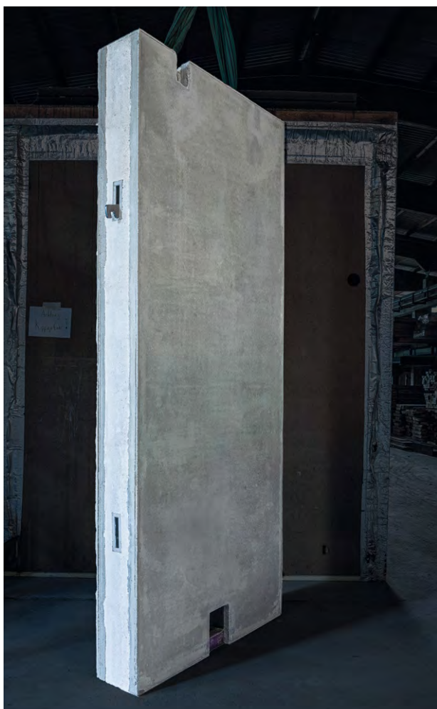
Eine vorgefertigte Wand aus Gradientenbeton.
