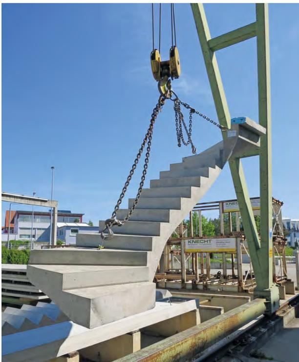
Betonfertigteiltreppen sind direkt nach der Montage begehbar.
