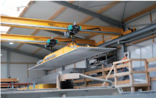
Dünne CPC-Platten in der Produktion und als Praxisbeispiel bei der Eulachbrücke, der leichtesten Betonbrücke der Welt.
