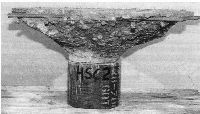
Bild 1 Versagen durch Durchstanzen [7] Fig. 1 Punching failure
